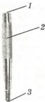
Рис. 17. Кернер: 1 — боек, 2 — стержень, 3 — рабочая часть
